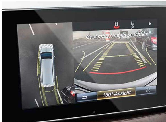
ระบบช่วยนำรถเข้าจอด Active Parking Assist พร้อมกล้องแสดงภาพแบบรอบทิศทางขณะถอยจอด
