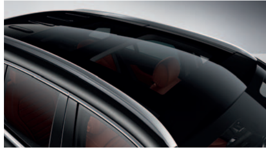
หลังคาพาโนรามากระจกชนิดรูดเลื่อนเปิด-ปิดได้ด้วยระบบไฟฟ้า (Electric panoramic sliding glass sunroof) สำหรับรุ่น GLC 250 d 4MATIC AMG Dynamic
