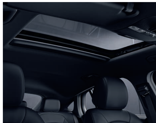
หลังคาซันรูฟ เลื่อนเปิด-ปิดได้ด้วยระบบไฟฟ้า
