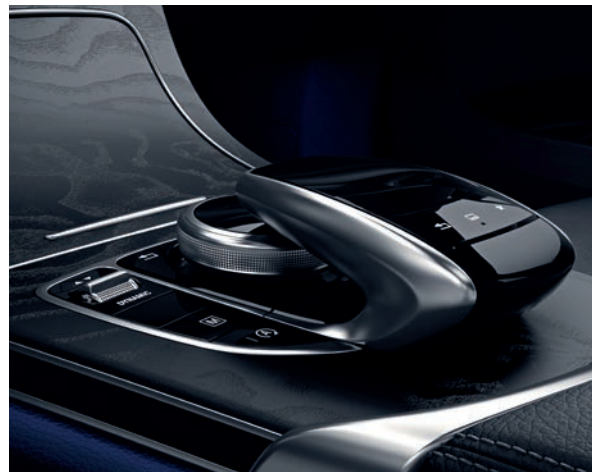
ระบบควบคุมและสั่งงานด้วย touchpad
